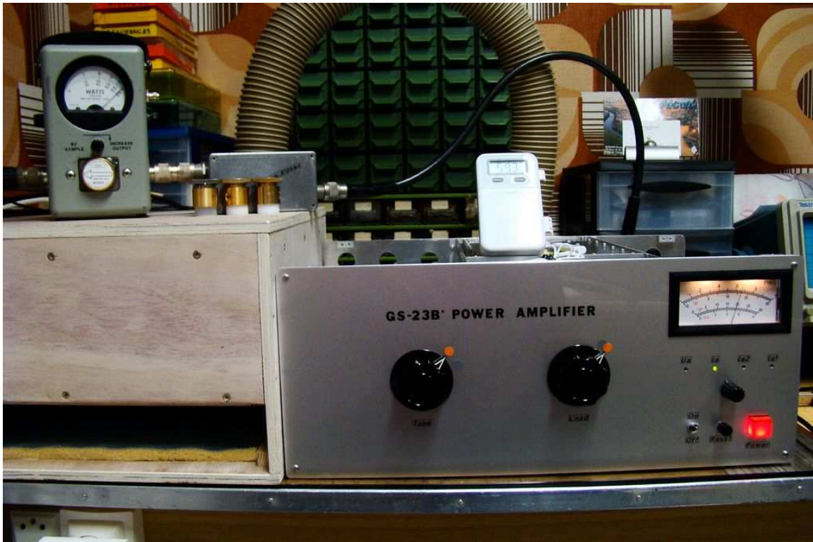
Les tests du PA ( à gauche , le caisson de ventil déporté )
