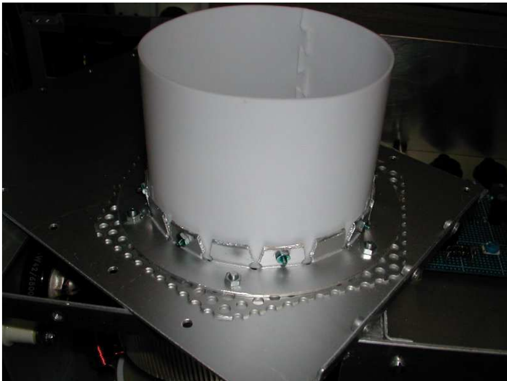
La cheminée de refroidissement
