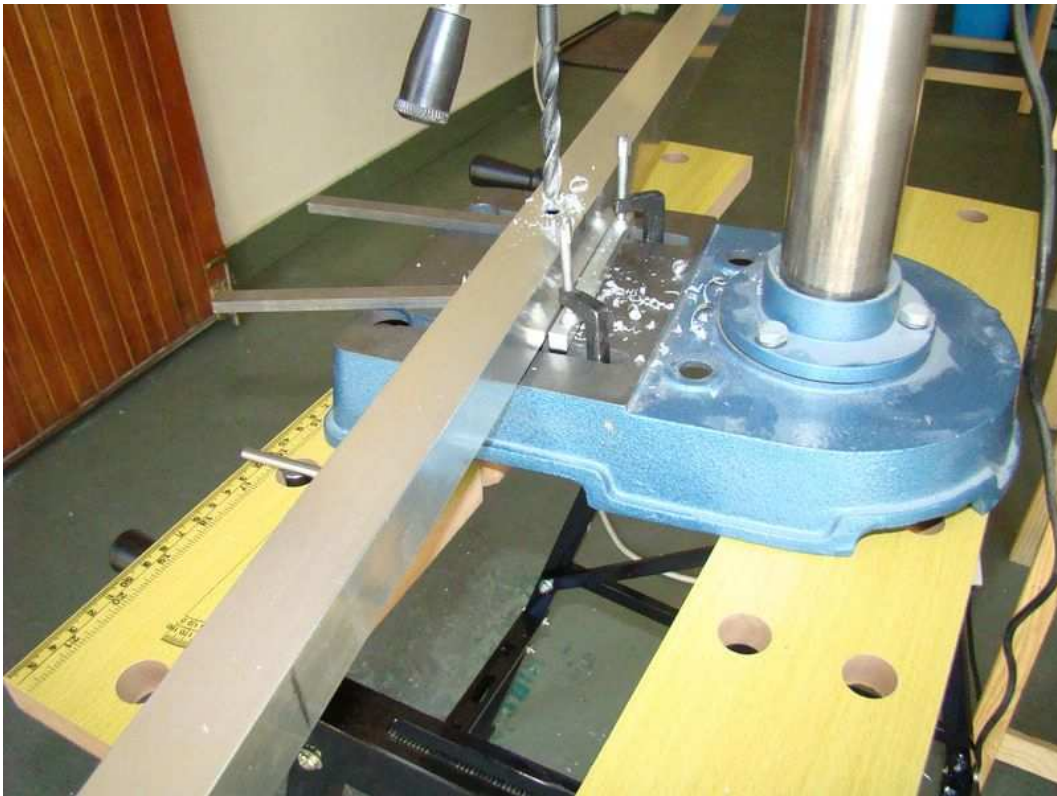
Perçage du boom
