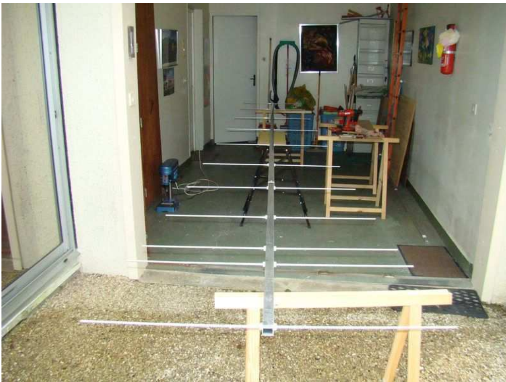
Montage des éléments
