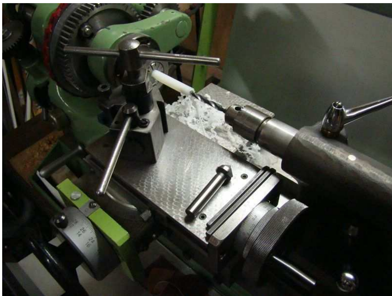
Percement des isolateurs d'éléments ( tige filetée en Nylon )
